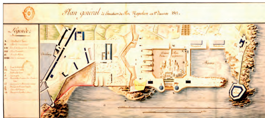
Plan général de situation du Port Napoléon au 1 er janvier 1812 (Service historique de la défense). Ce plan est une « photo de chantier » destinée à informer le pouvoir central de l'état d'avancement des grands travaux impériaux. Il relate précisément l'état du creusement de l'avant-port, isolé de la rade par un batardeau.
