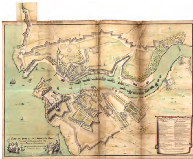
Plan du port et de l'arsenal de Brest, 1676 (SHD Marine). Les bâtiments de l'arsenal naissant sont essentiellement disposés de part et d'autre de l'anse de Pontaniou, en rive droite. En rive gauche, la corderie s'étire le long de l'anse de Troulan.
