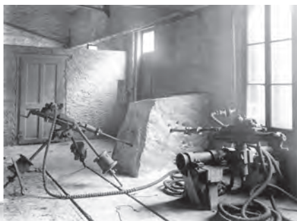
Perforatrices pneumatiques à percussion actionnées par air comprimé.
