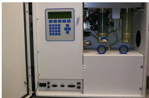
Figure 20 : Systèmes de prélèvement actifs permettant des prélèvements séquentiels
