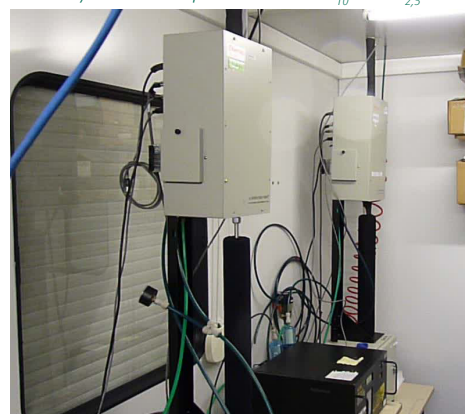
Analyseurs TEOM pour mesure PM_{10} et PM_{2,5}
