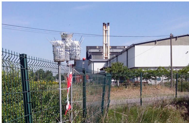
Figure 22 : Mesures des flux de dépôts atmosphériques par jauges de sédimentation
