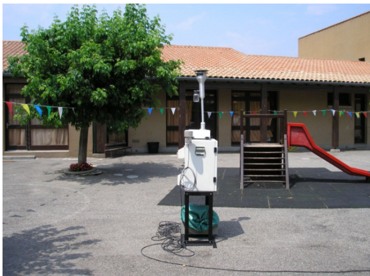
Figure 18 : Préleveur sur filtres de particules en suspension permettant la détermination des concentrations massiques en PM_{10} et ETM associés
