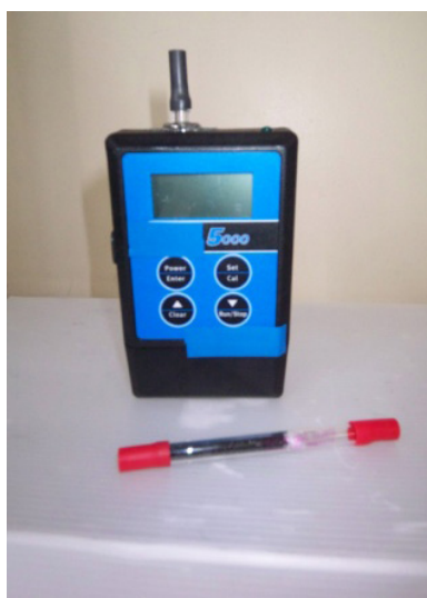
Figure 19 : Systèmes de prélèvement actifs autonomes sur 24 H
