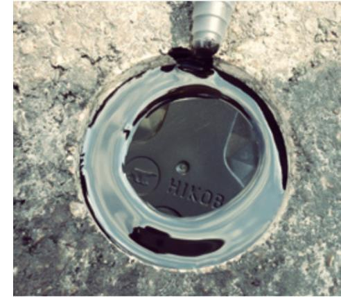
Issu d'un partenariat avec la start-up Hikob, ce système novateur permet la collecte en temps réel des informations liées aux évolutions climatiques sur le réseau routier. Le déclenchement des interventions de viabilité hivernale est ainsi optimisé.
