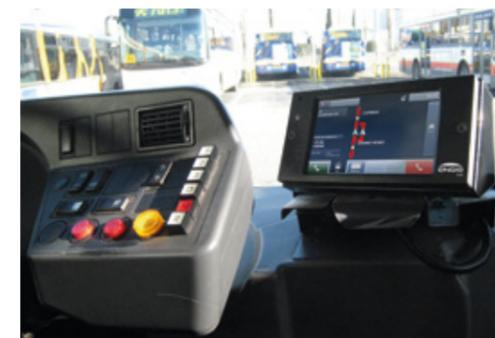
Navinéo est un système qui permet le suivi en temps réel d'une flotte de bus par géolocalisation. Développé par la société Engie Ineo, de nombreux services en découlent : régulation des bus, information des temps d'attente en station, gestion des incidents et des demandes de priorité aux feux.
