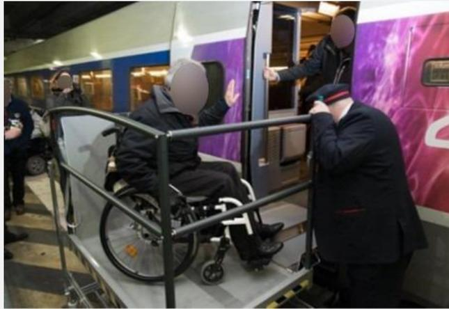
Plateforme élévatrice pour quais réduits.
