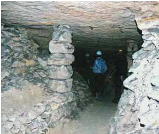
Photo d'une exploitation par hagues et bourrages (INERIS)
