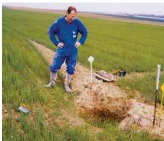
Exemples d'affaissements en surface – souterrain refuge (INERIS) et marnière (CETE Normandie-Centre)
