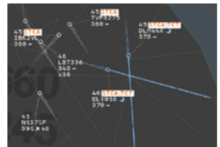
Le filet de sauvegarde (STCA) alerte le contrôleur lors d'un rapprochement dangereux entre aéronefs en vol
