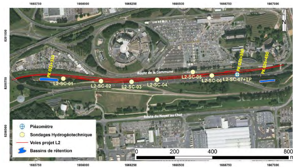
Figure 60 : Localisation des sondages issus de la campagne d'investigations réalisées par Hydrogéotechnique au droit de la zone L2
