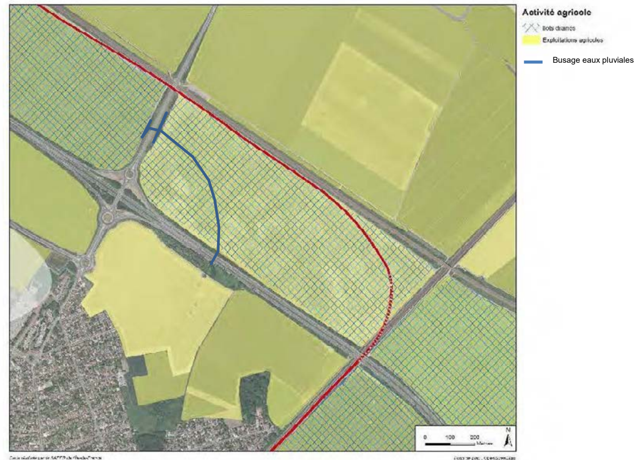
Figure 167 : Busage des eaux pluviales vers le bassin d'orage
