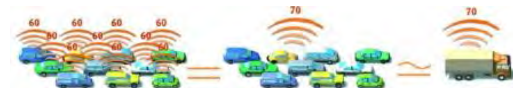
Figure 249 : Addition de 10 sources sonores de même intensité (Source : Bruitparif)
