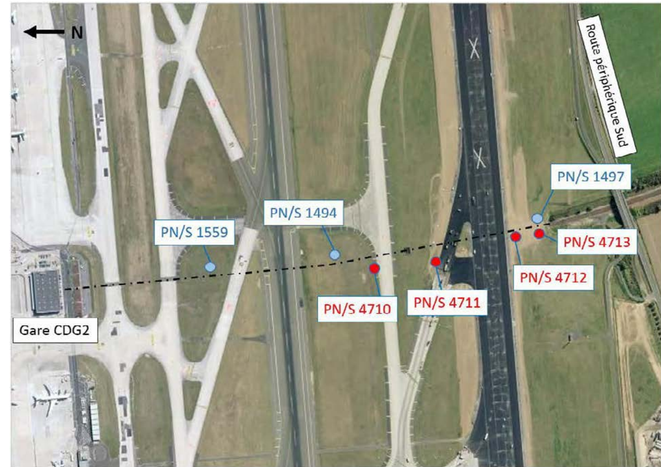
Figure 57 : Localisation des piézomètres de la zone H (source : ADP)
