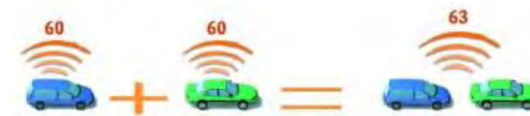
Figure 248 : Addition de deux sources sonores de même intensité (Source : Bruitparif)
