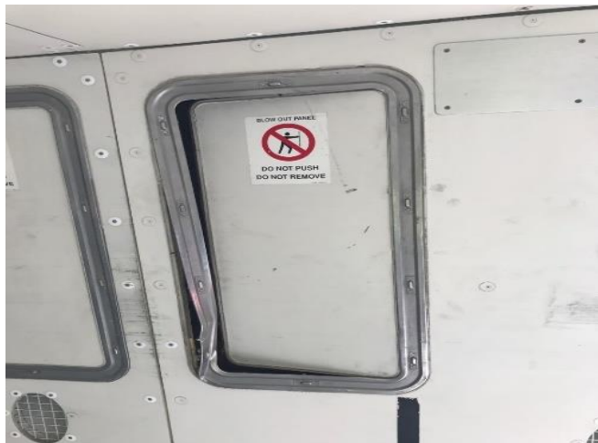
Panneau de décompression endommagé
