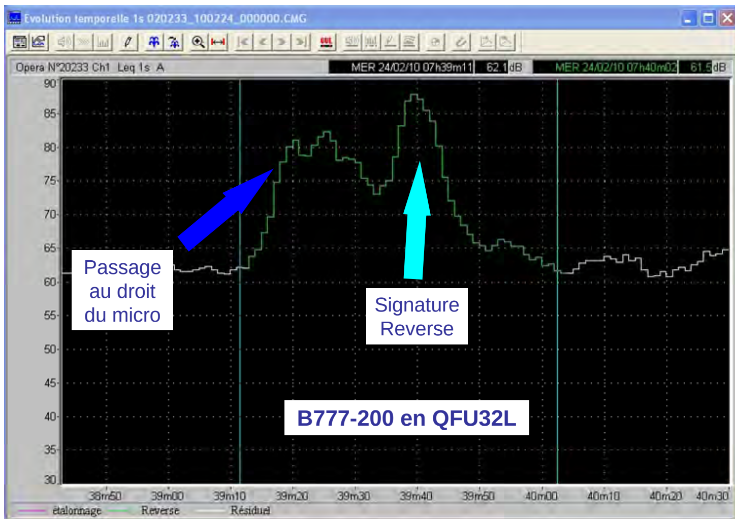
Figure 25 : Extrait d'enregistrement le 24 février 2010, arrivée d'un B777-200 en 32L avec utilisation identifiée des inverseurs de flux
