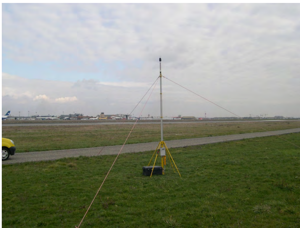
Figure 24 : Implantation du capteur sonore pour l'étude des arrivées en QFU32L. Le capteur sonore est alimenté électriquement par deux batteries externes.
