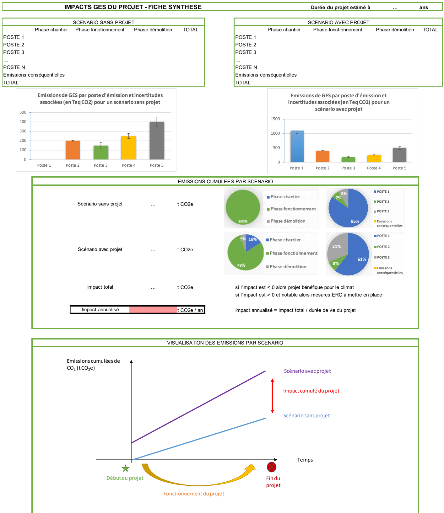
Figure 6 : exemple de présentation de l'impact d'un projet sur les émissions de GES
