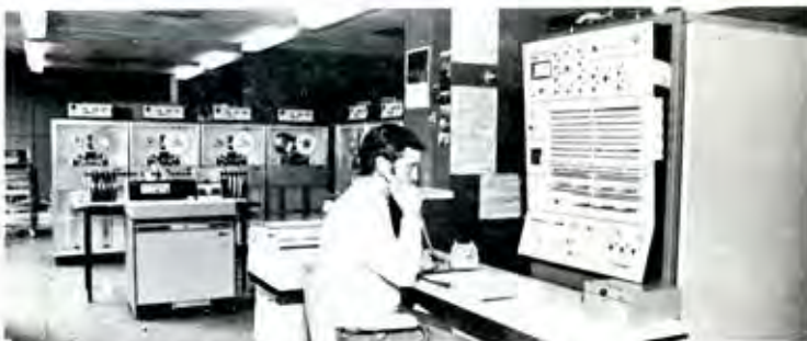
La salle d'ordinateurs (ici celle du SETRA à Bayonne). On peut remarquer qu'il s'agit ici d'une configuration assez importante. Une telle configuration est requise pour la plupart des programmes du système SETRA. Elle peut permettre, en outre, le traitement à distance.
