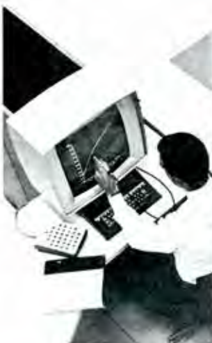
Unité de visualisation - Avec utilisation du photostylisme permettant la détection d'informations sur l'écran au moyen d'une cellule photoélectrique.
