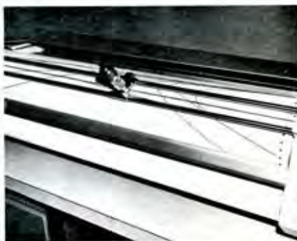
Machine à dessiner - automatisation simple, qui permet de déplaçant automatiquement des commandes numériques enregistrées sur bandes magnétiques.
