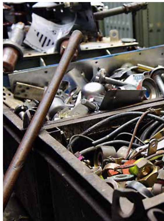
Déchets industriels contenant du pyralène avant leur retraitement
