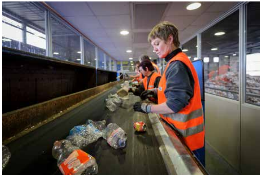
Cabine de tri des corps creux (déchets ménagers constituée des verres, plastiques, briques alimentaires, acier, aluminium) © Arnaud Bouissou/Terra
