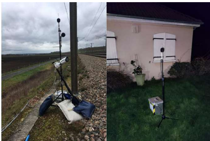
Figure 6: illustration des systèmes de mesures utilisés par la SNCF sur les sites LGV. A gauche, le système à proximité des voies composés de microphones et caméra vidéo (+ jauge de contraintes). A droite le microphone et sa batterie posé chez un riverain. Source : SNCF
