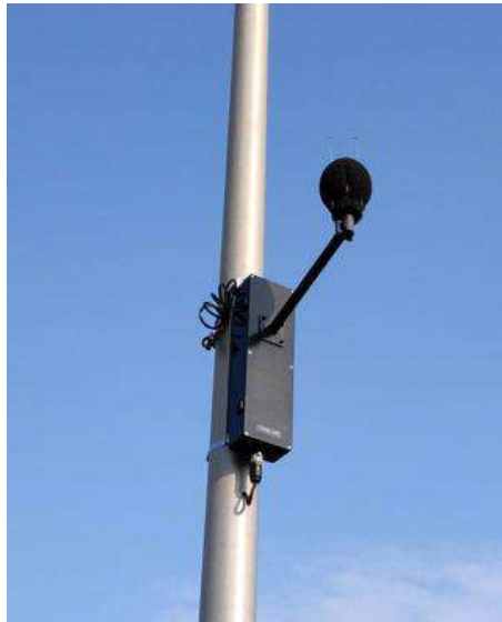
Figure 2: •Sonomètre classe 1 de type RION NL52 muni d'un microphone RION UC-59 et d'une protection anti-intempéries WS-15 et routeur pour l'envoi automatique des données vers le serveur de Bruitparif
