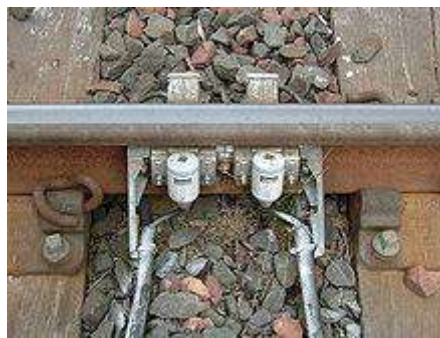
Figure 51: Exemple de pédale de voie électronique permettant la détection du passage d'essieux. Ce type de dispositif pourrait s'avérer plus efficace que les jauges de contraintes susceptibles de fournir des signaux bruités difficilement exploitables.
