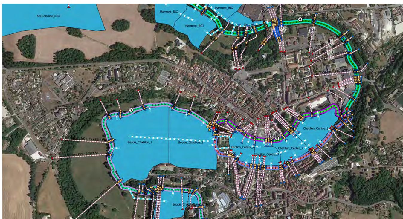
Illustration 22 : représentation du modèle 1D-casiers réalisé avec le plugin Mascaret autour de la commune de Chatillon-sur-Seine (21) (Source : Cerema).
