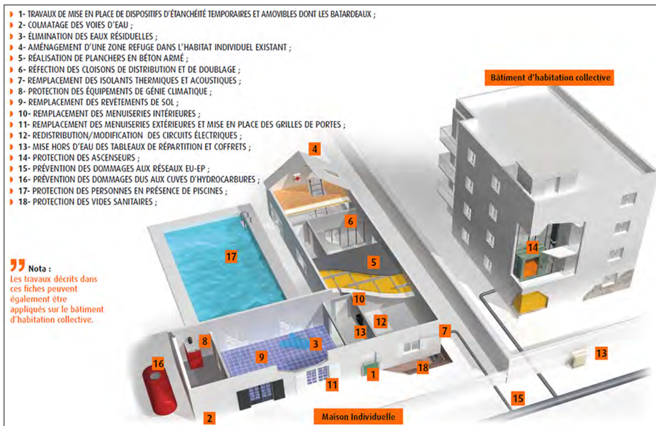
Illustration 39 : travaux de réduction de la vulnérabilité des habitations individuelles. Source : référentiel de travaux de prévention du risque d'inondation dans l'habitat existant (MELT/MEDDE, 2012).
