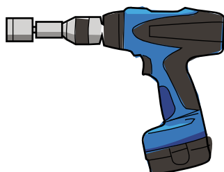
Figure 54 : Visseuse munie d'une butée de profondeur
