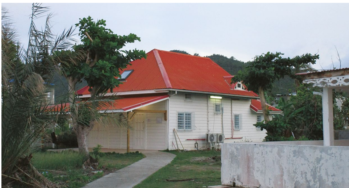
Figure 1 : Toiture de bonne conception (quatre pans, pente adaptée, auvent déconnectée de la toiture)
