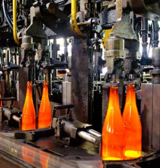
Arnaud Bouissou / Terra Machine de production côté finisseurs et convoyeurs
