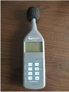
Figure 5: Sonomètre
