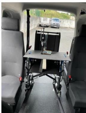
Figure 3: Fauteuil avec outil de mesure pour le rebond
