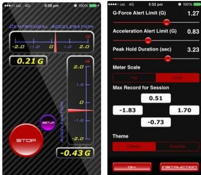
Nous avons mesuré l'accélération centrifuge longitudinale et latérale grâce à une application mobile g-force.
