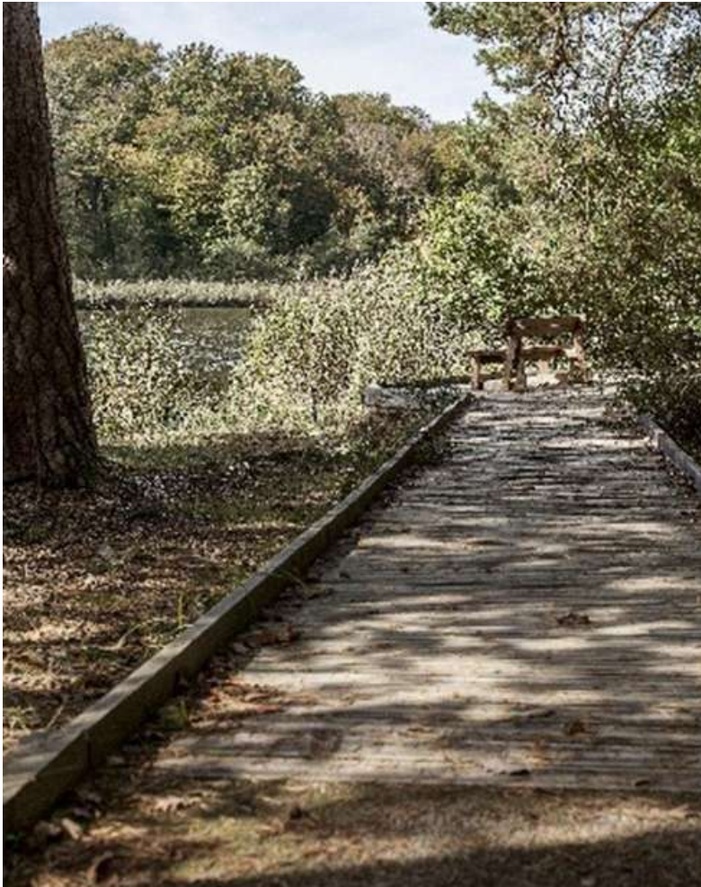
Platelage bois au sein d'un milieu forestier, avec un fil d'Ariane/chasse-roues de chaque côté du cheminement - ©ONF
