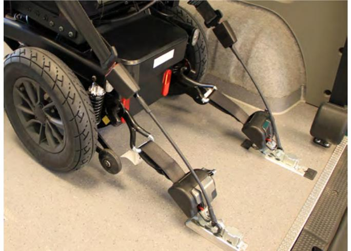
Figure 3 : arrimage par sangles (vue arrière)
