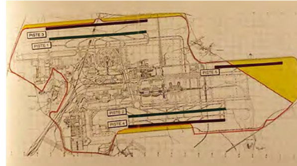
Roissy-CDG : avant-projet de plan de masse avec 3 nouvelles pistes (1992). En jaune sur la carte, le besoin d'acquisition de nouveaux terrains.
