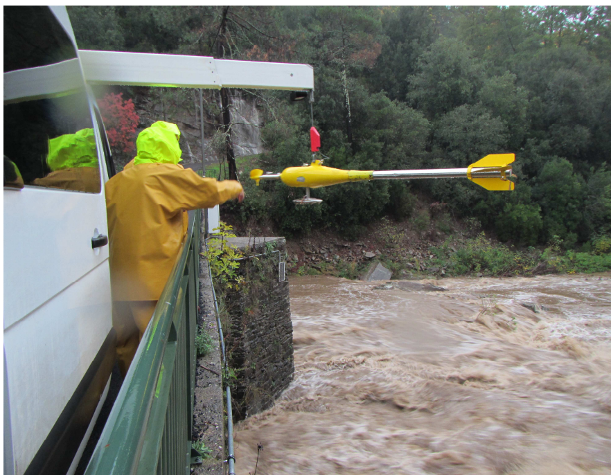
Une équipe d'hydromètres s'apprête à estimer le débit d'une rivière en crue à l'aide d'un matériel de jaugeage appelé saumon.
