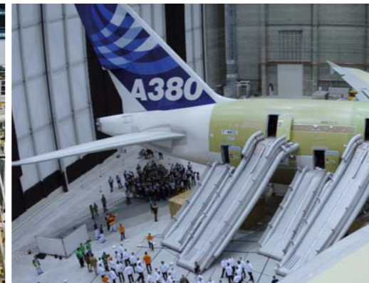
La réussite du test d'évacuation de l'A380 constituait l'une des dernières étapes en vue de la certification de l'appareil.
