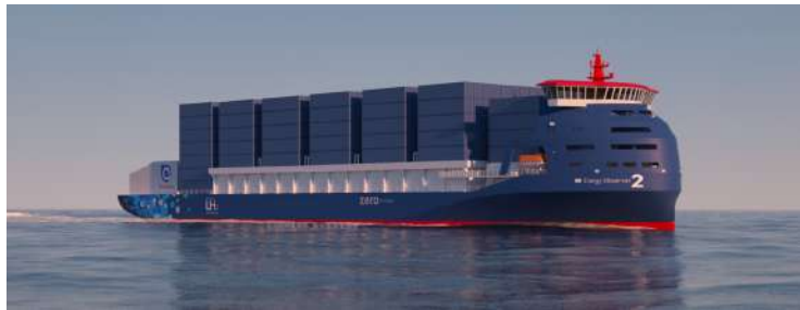
Energy Observer 2 - navires de charge polyvalent et électrique alimenté par de l'hydrogène liquide (crédits : Kader Boucher / Epron Design )
