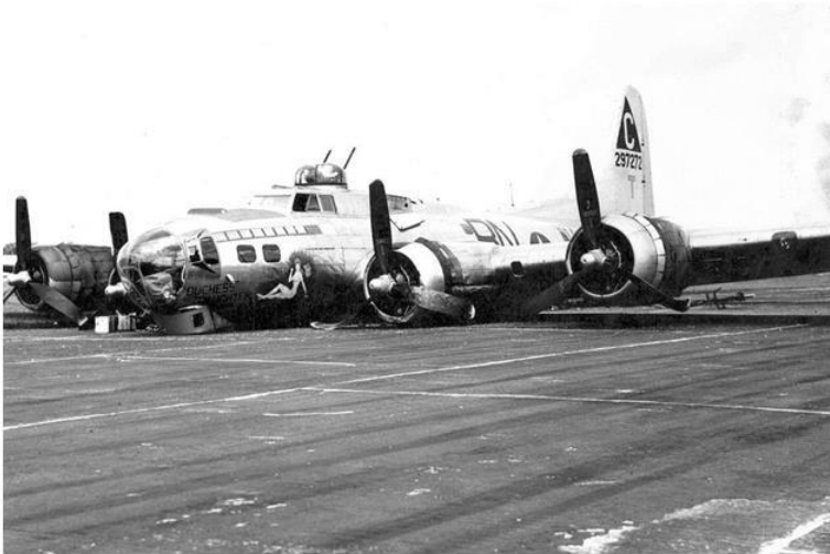
Boeing B-17, Dutchess' Daughter, après un "belly landing" dû à une erreur du pilote (1944)
