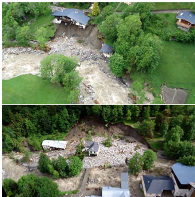
Illustration 22 : affouillements par le Bastan à Barèges, Hautes-Pyrénées – juin 2013 (©ONF-RTM).
