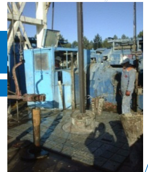
Tiges de forage (ensemble de tubes en acier vissés).
