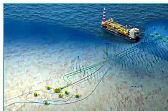
Installation de production flottante : les têtes de puits sont fixées sur le fond de la mer et sont reliées au navire par des conduites de production.
