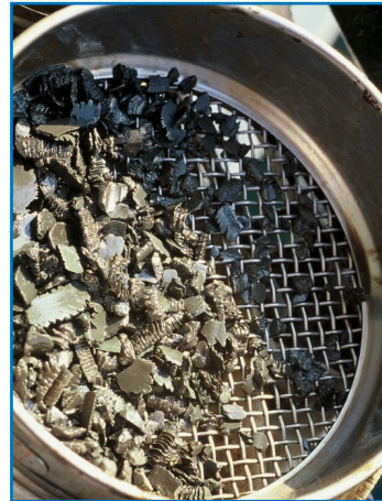
Débais de roche broyée, analysés en continu lors du forage.
