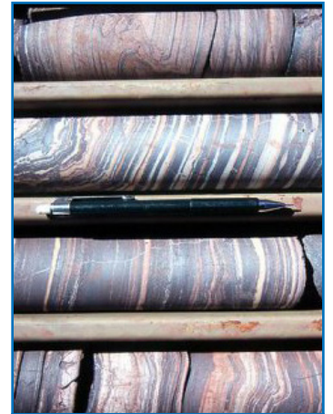
Carottes extraites des puits, prélevées uniquement dans les zones cibles.
