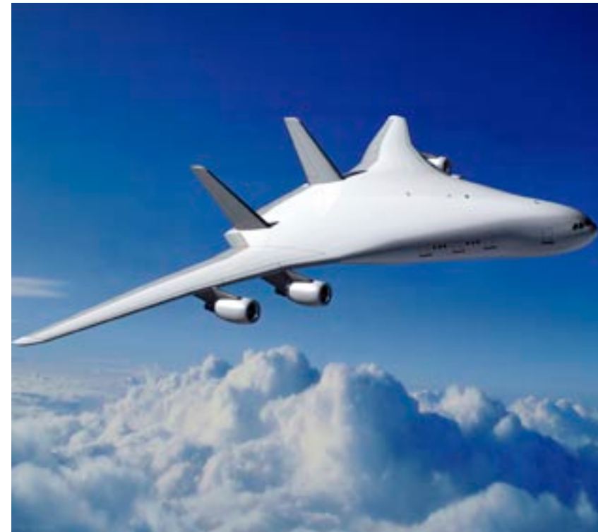
Aile volante Vela (Very Efficient Large Aircraft). Ce projet européen, piloté par Airbus, étudie également l'architecture, l'aérodynamie et la mécanique des avions du futur.
