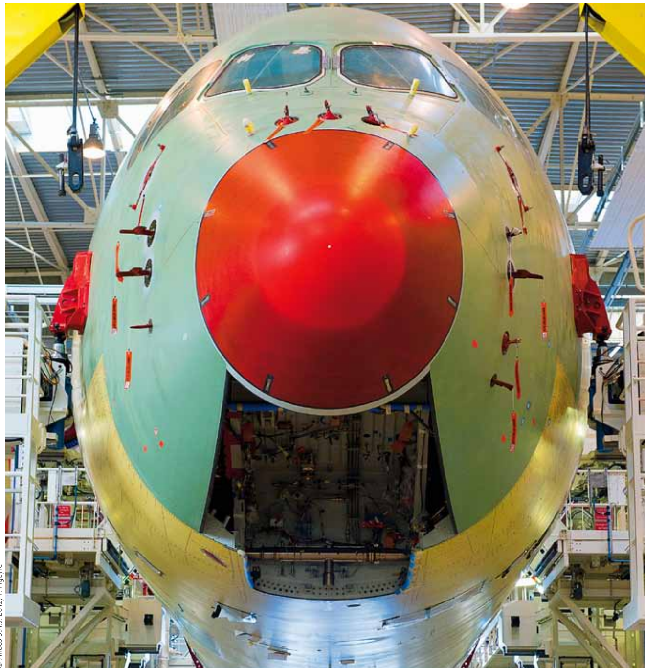
Assemblage final du fuselage de l'A350 XWB sur la chaîne de montage, à Toulouse, qui dispose de gabarits mobiles pour adapter les différentes longueurs des versions A350-800, -900 et 1000.
