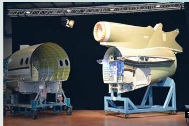
1. Ressorts Masselin : fournit tout type de ressorts techniques sur plan. 2. Duqueine : cadres de fuselage de l'A350. 3. Potez : tronçons 4 et 5 du Falcon 900 de Dassault-Aviation.
