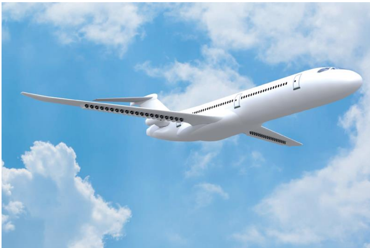
Concept DRAGON de l'ONÉRA : vise à évaluer les avantages et les inconvénients de la propulsion électrique distribuée pour un avion de ligne (150 passagers et une vitesse de croisière autour de Mach 0.8)
