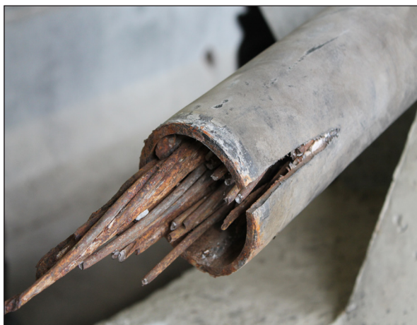
Rupture par corrosion d'un câble de précontrainte, coulis d'injection enlevé - Gaine en PEHD (photo GRA3)
